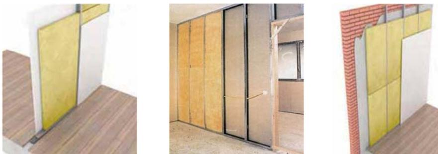
Para las estancias secas, estar-comedor, habitaciones, vestidor y pasillos, se opta por mantener la estructura de perfiles de chapa de acero galvanizado, aislamiento a base de lana de roca y cambiar el acabado del paramento vertical interior por enlistonado de madera de abeto machihembrada o similar.
